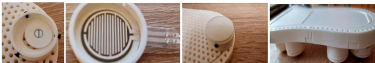
Figura 6. Senzor montat pe talpa sandalei—prototip de imprimantă 3D, ABS—detaliu de poziționare folosind excentric, detaliu de montare a senzorului în carcasă.
